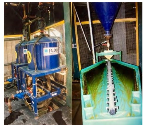
Figura 4. Concentrador centrífugo Falcon Modelo F-1 SB-750. Figure 4. Centrifugal concentrator Falcon Model F-1 SB-750.
