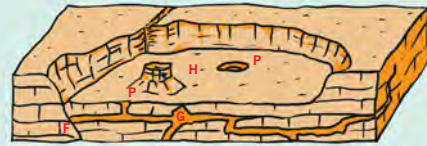
FIGURA 28. Representación de la formación de un poljé y elementos habituales en ellos. H: relieve residual o hum, P: sumidero o ponor, G: galerías subterráneas, F: falla.
