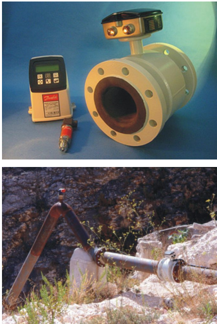
Figura 2. Caudalímetro electromagnético y transductor de presión. Colocación en tubería
