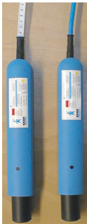
Figura 10. Sensor inteligente Dipper de Seba
