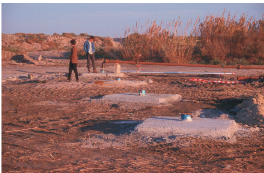
Foto 6. Enjambre de cuatro piezómetros en el delta del Andarax (Almería), que serán equipados para seguimiento de la evolución del nivel, temperatura y conductividad del agua en el agua dulce, franja de transición y agua salada.
