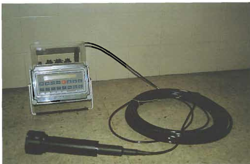
Para minimizar los efectos nocivos de la colmatación se usan un turbidímetro que cuantifica la materia en suspensión que lleva el agua a recargar. La instalación de infiltración debe permitir que, en caso de superarse un determinado límite máximo de sólidos en suspensión, se retorne el agua al río Girona para evitar el deterioro de los pozos utilizados para la recarga.
