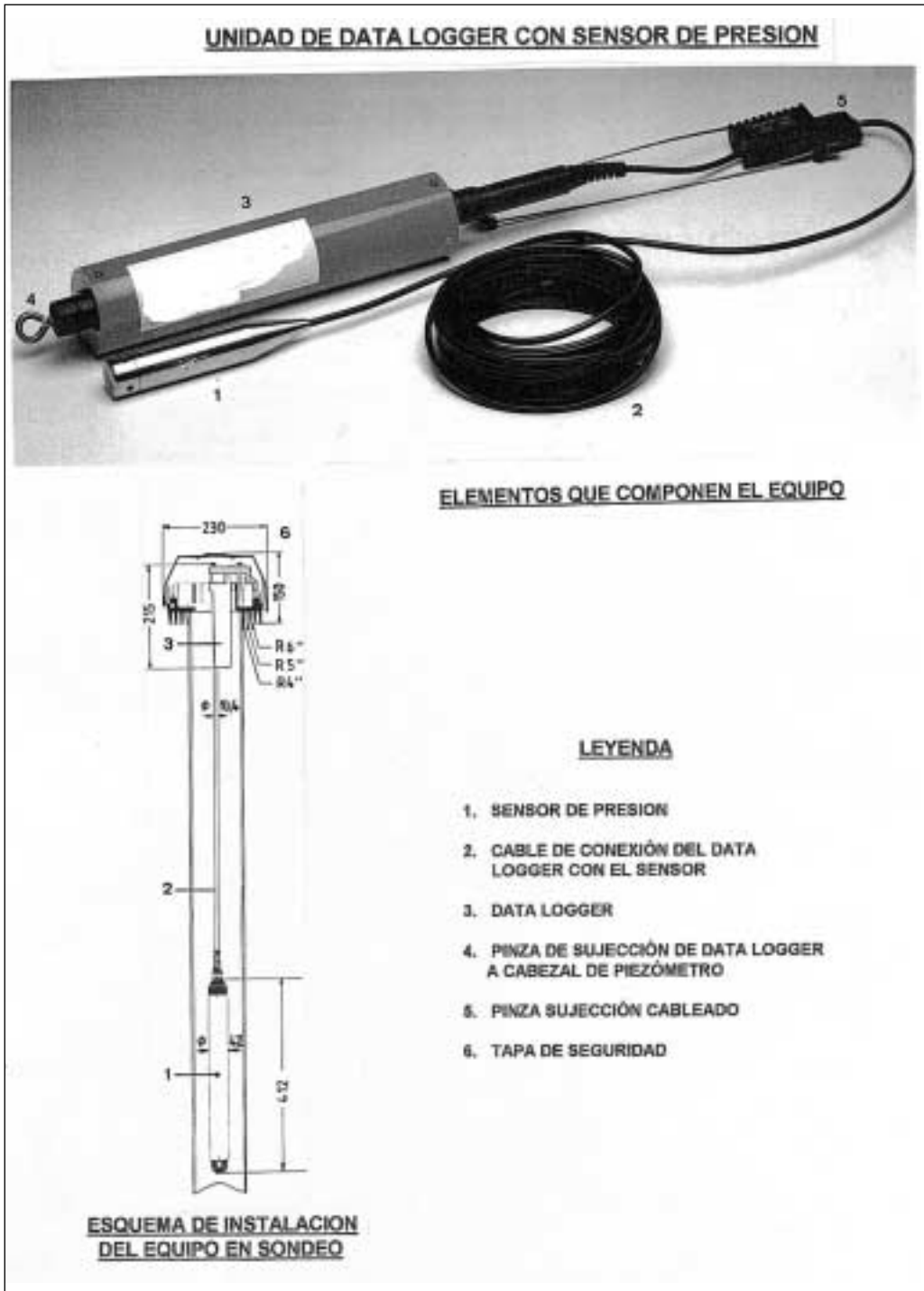
Figura 2. Elementos del equipo automático de medida del nivel piezométrico.
