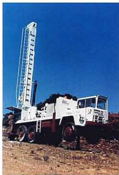
Moderna máquina de rotopercusión del RTGE. (14)
