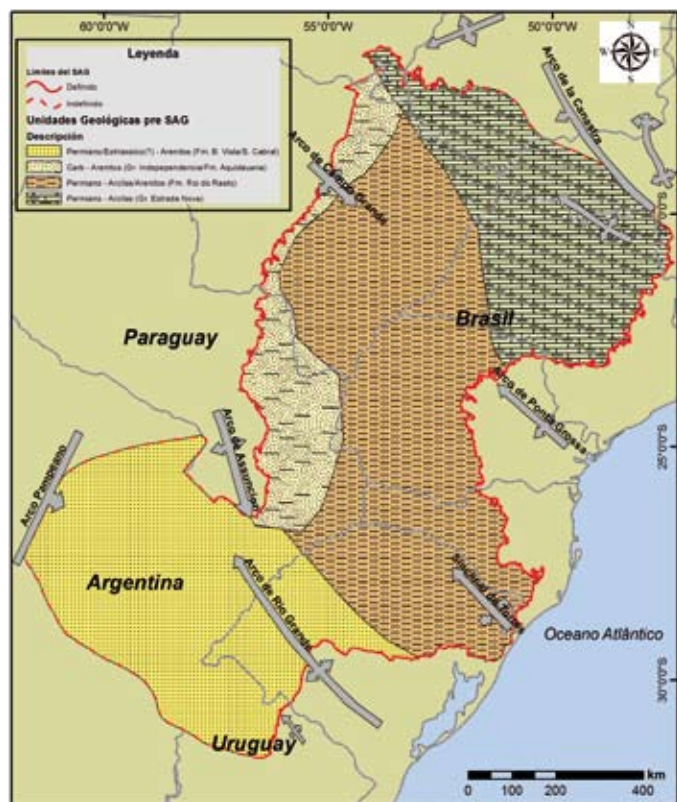
Figura 2. Mapa geológico simplificado del substrato del Sistema Acuífero Guaraní.
